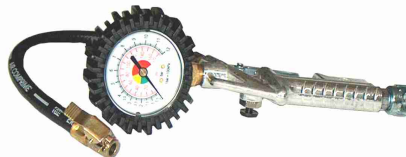
Art. 54.230.0022 Pistola di gonfiaggio con manometro Inflating gun with manometer • Ø 63 mm, bar 0: 10 • con tubo di gomma (400 mm) e testina, • con valvola di scarico per eccedenza di pressione
